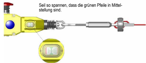
Abb. 3 Spannen des Seils mit Seilmontagesystem ZTK
