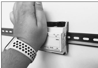
Gerät auf Hutschiene drücken
